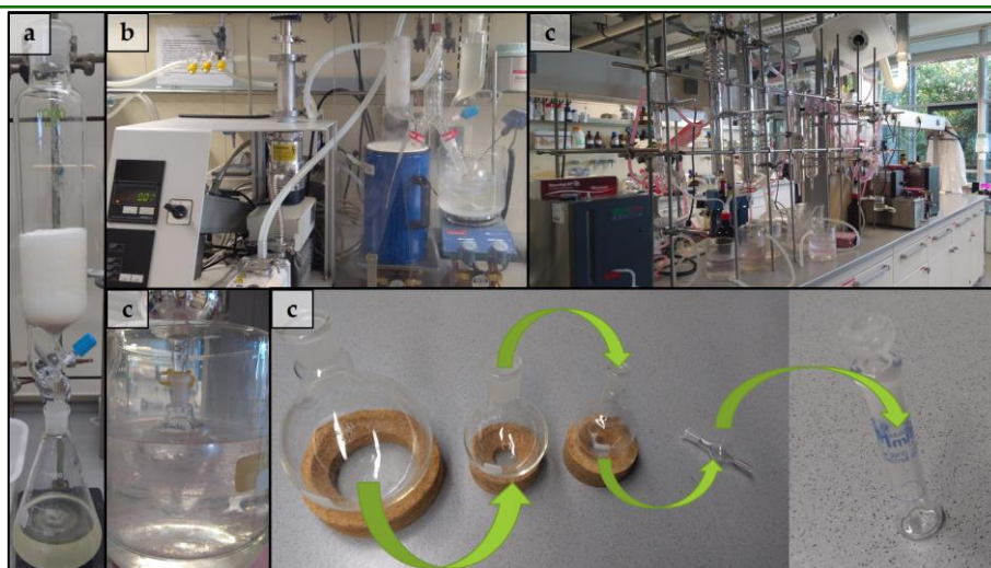
Rys. 6 Przygotowanie ekstraktu do analizy chromatograficznej; a – homogenizacja i ekstrakcja rozpuszczalnikiem organicznym; b – SAFE; c – zagęszczanie ekstraktu do finalnej objętości 1 cm 3
