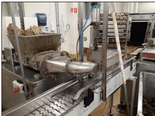
Rys. 6. Dzielarka przeznaczona do ciasta pumpernikla. Fotografia własna.
