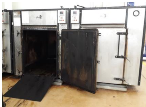
Rys. 10. Piec wsadowy służący do fermentacji ciasta oraz wypieku pumpernika. Fotografia własna.
