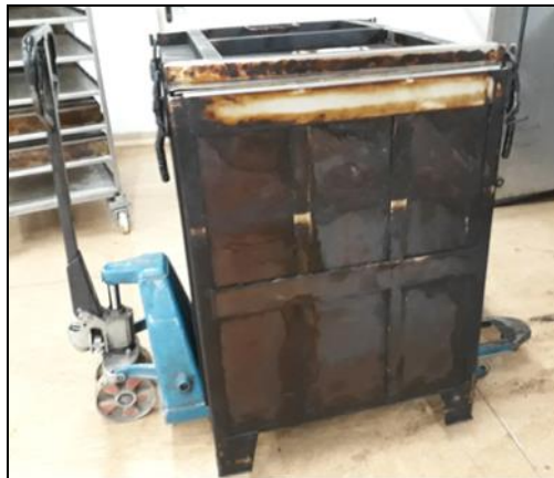
Rys. 9. Szczelnie zamknięte formy z kęsami ciasta przygotowane do procesu fermentacji. Fotografia własna.
